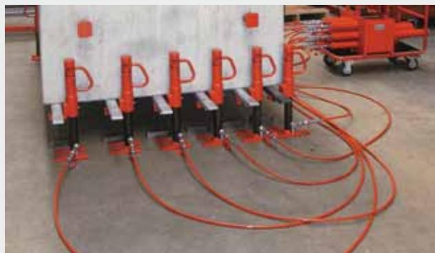
Sonderdruckblock zum synchronen Anheben mit 12 Hebegeräten
