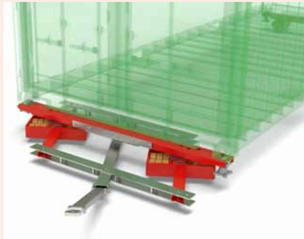
Beispiel: Container Traverse passend zu Standard-Tandemlenkwerken. Die Traverse wird mit den Drehtellern durch Verschraubung fest verbunden und bildet so eine sichere Transporteinheit.
